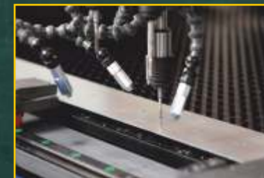
Druckluftgestütztes Gewindeschneiden mit TapOne 1212.
